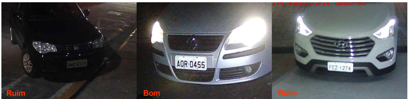
Figura 46 - Efeito do iluminador nas placas
