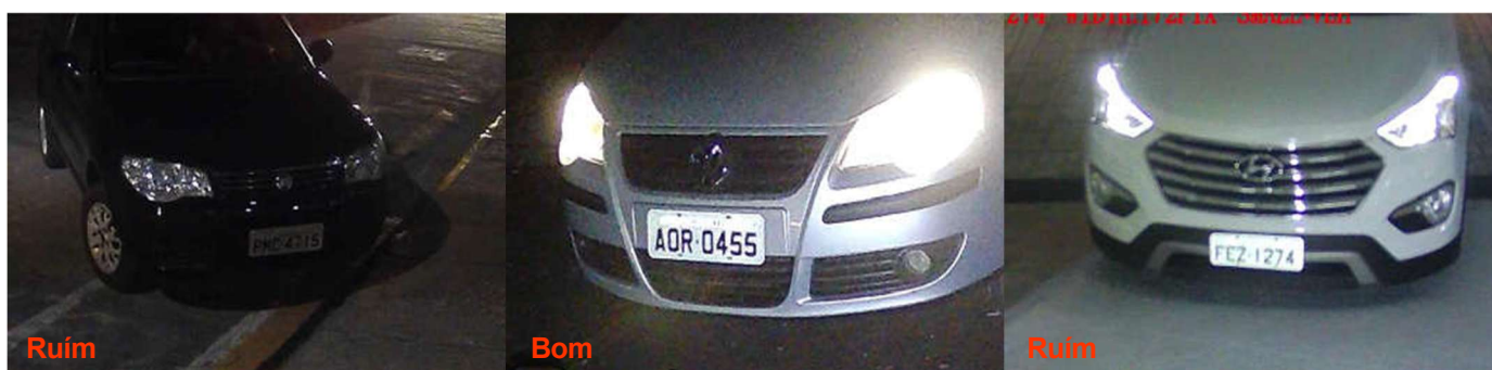
Figura 47 - Efeito do iluminador nas placas
