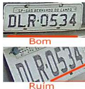
Figura 19 - Nivelamento da placa
