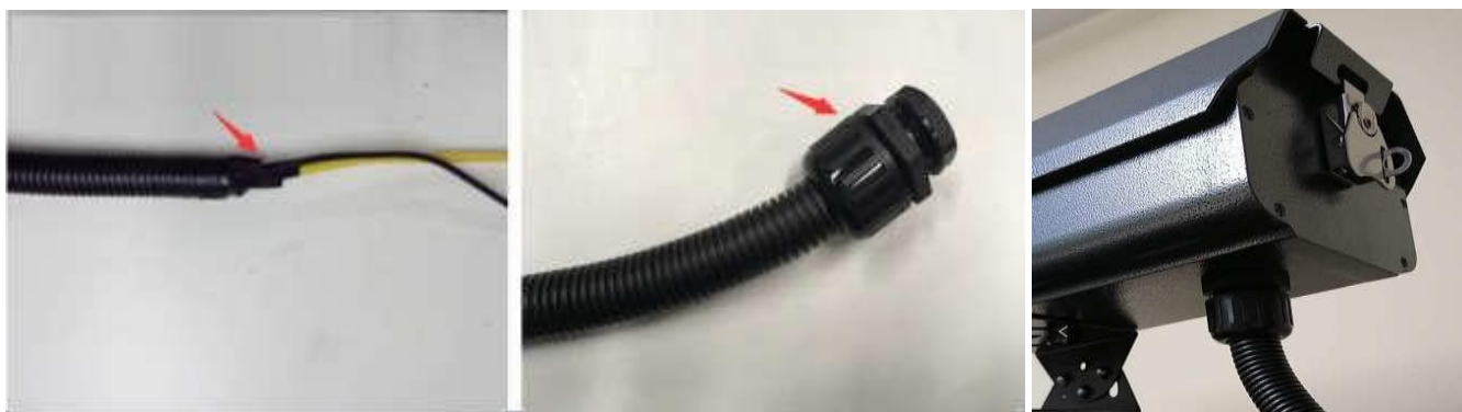
Figura 21 – Vedação prensa cabos da caixa da câmera LPR
